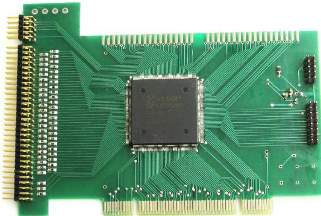
Рис. 2. “Квантохрон 4-48” — система регистрации и хронометрирования потоков случайных событий.
