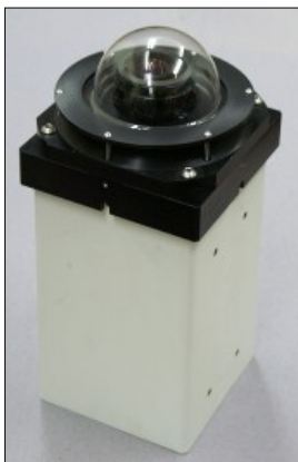
Рис. 7. Широкоугольная цветная ПЗС-камера для обзора ночного неба (слева), интегрированный метеомодуль с инфракрасным датчиком контроля облачности (в центре) и узкоугольная камера для определения прозрачности.
