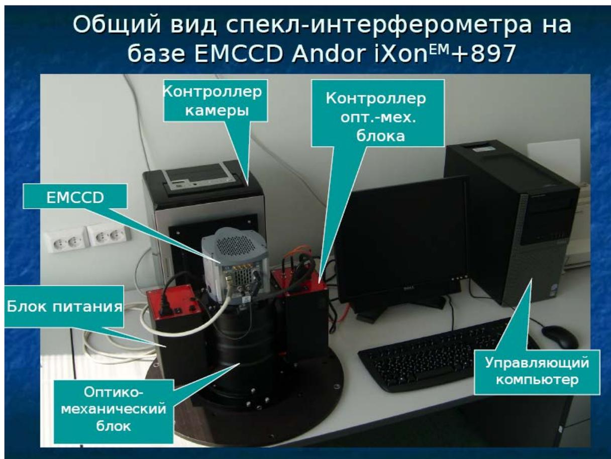
**Рисунок 12.** Общий вид спекл-интерферометра на базе EMCCD Andor iXon+897, в ходе лабораторных пуско-наладочных работ.
