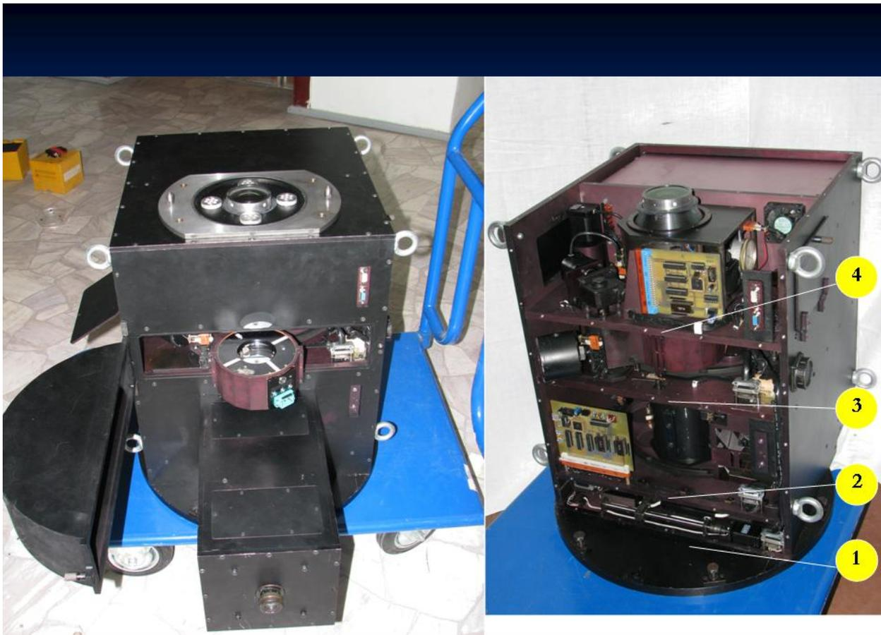
**Рисунок 13. Общий вид нового фокального редуктора светосилы для УСУ БТА.**
