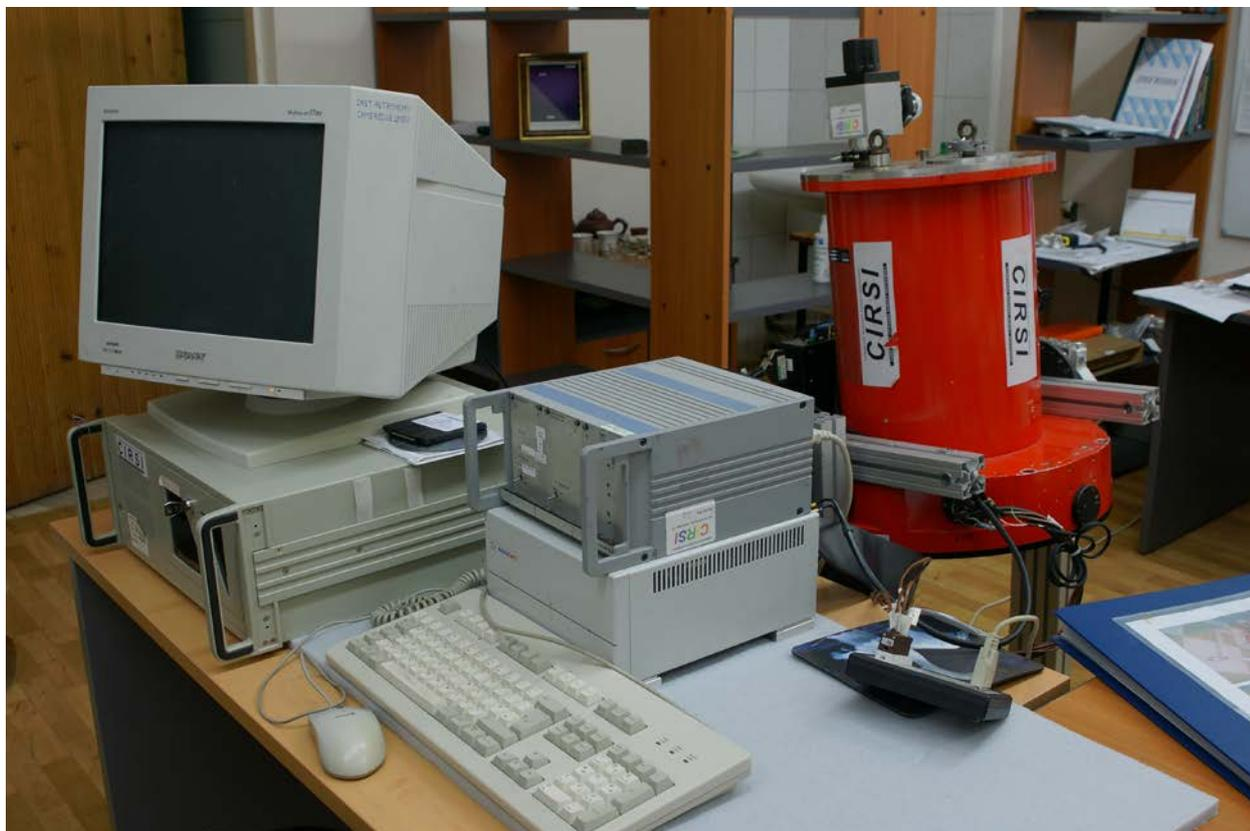
**Рисунок 15. Общий вид системы регистрации для изображений ИК-диапазона на телескопах БТА и Цейсс-1000.**
