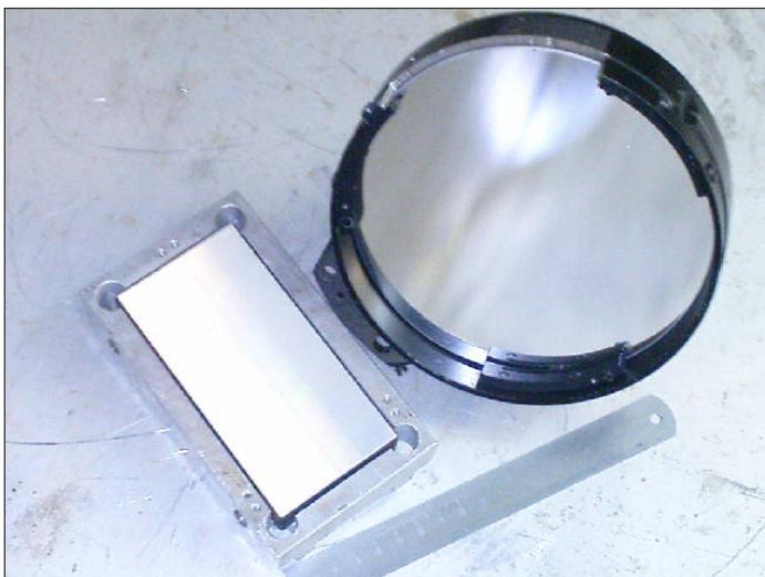
Рисунок 44 - Фото основных оптических элементов: дифракционной решетки (слева) и параболического вогнутого зеркала.
