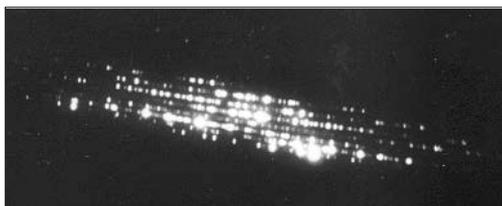
Рисунок 36 - Эшелле спектр сравнения, зарегистрированный при помощи двумерного счетчика фотонов. Вокруг ярких линий видны ореолы рассеянного света.
