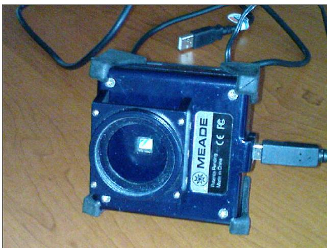
Рисунок 45 - Фото светоприемника с вентилятором охлаждения (закреплен с тыльной стороны камеры). Видна площадка матрицы ПЗС.
