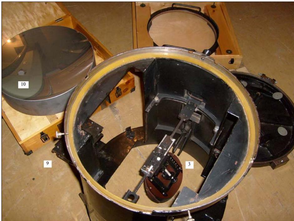
Рисунок 55 - Фотография набора элементов светосильной камеры, сделанная под другим ракурсом. Обозначения: 3 - ломающее плоское зеркало, работающее в сходящемся пучке системы "ломаный Шмидт", 9 - узел крепления и юстировки светоприемника, 10 - дефект на поверхности главного зеркала (матовое пятно).
