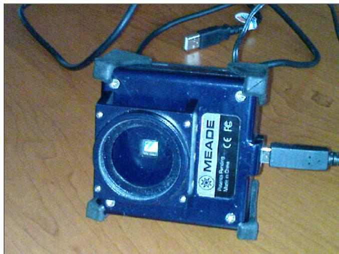
Рисунок 59 - Фото светоприемника с вентилятором охлаждения (закреплен с тыльной стороны камеры). Видна площадка матрицы ПЗС.
