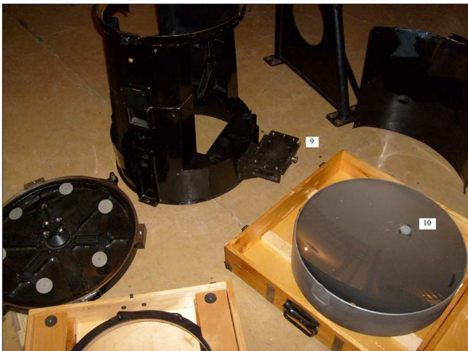
Рисунок 56 - То же, что и на рисунке 55, под другим ракурсом. Обозначения: 9 - узел крепления и юстировки светоприемника, 10 - дефект на поверхности главного зеркала (матовое пятно).
